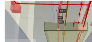
効率的な地下埋設物モデル作成手法及びBIMモデルとの連携システムを開発し、埋設物照会等を支援
