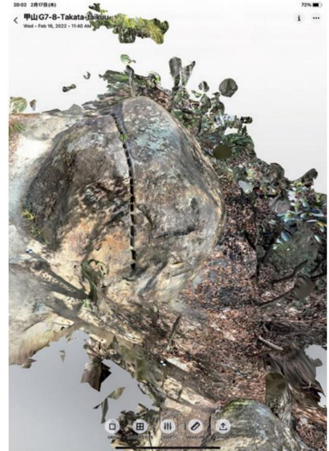
図8 iPadによるLiDAR計測した徳川大坂城石丁場跡東六甲石丁場跡甲山刻印群G7番石材。計測時間は4分
