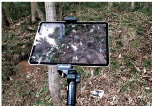
図5 MetascanによるLiDAR計測
