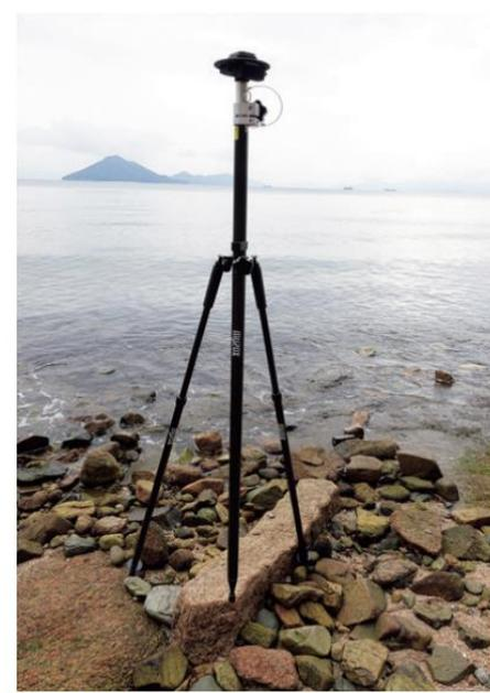
図6 RTK-GNSS測量の様子
