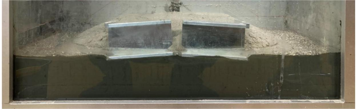
粘土地盤上における目開き実験の試行段階
