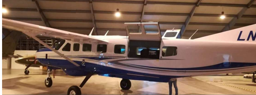
セスナ 208b グランドキャラバン. 2 ハッチ ALB 飛行速度: 120-140 knots (220-260km/h). ALB 飛行高度: 400-600m.
