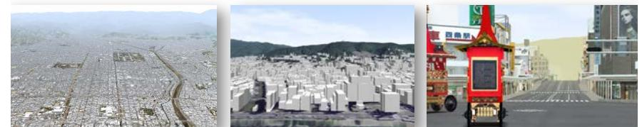
3次元景観モデル Virtual Kyoto: 41万の建物モデル(cm精度)を利用した建物別日照時間の居住地別格差を計測: 環境的公正の測定
