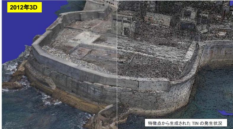
300 枚の画像を元にSFM-多視点画像3Dで生成した護岸の3次元モデルの一部。
