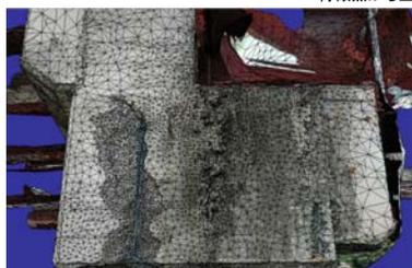
かぶりコンクリートの剥落の計測
