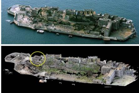
50カット(約20時間)で島の約8割を計測
